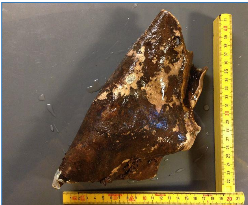
Kuva 15. Lyijylevy jonka yläreunassa näkyy reikä.
