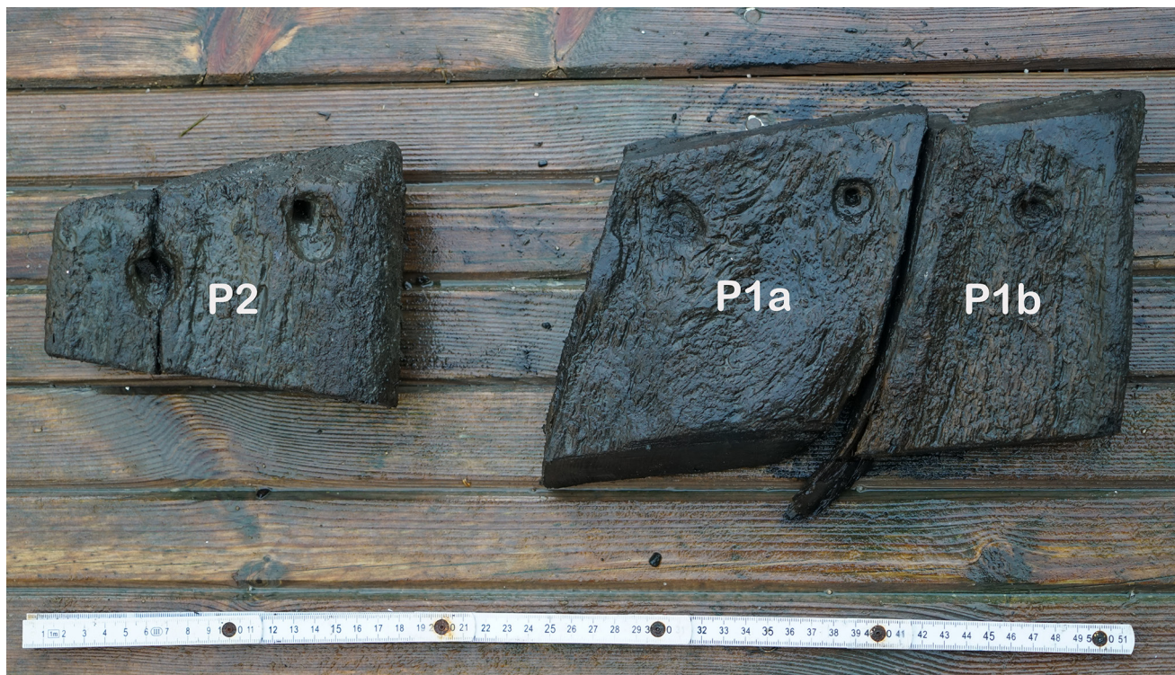
Figur 19. De tre proverna från vrakets bordläggning togs från bordhalsar vid babord akter. P2 är det ovan beskrivna berghultet och P1a och P1b är de två bordplankorna. Bordhalsarna har varit fästade i akterstäv med smidda järnspikar och de kvadratiska hålen efter spikarna syns tydligt på bilden. Foto: Staffan von Arbin/Bohusläns museum.
