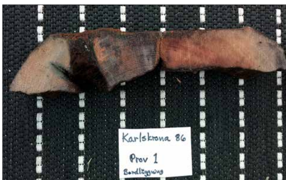
Figur 11. Endast ett av de tre proverna gick att datera och det var denna bordläggningsplanka som hade 140 årsringar. Foto: Jens Lindström/NMG.
