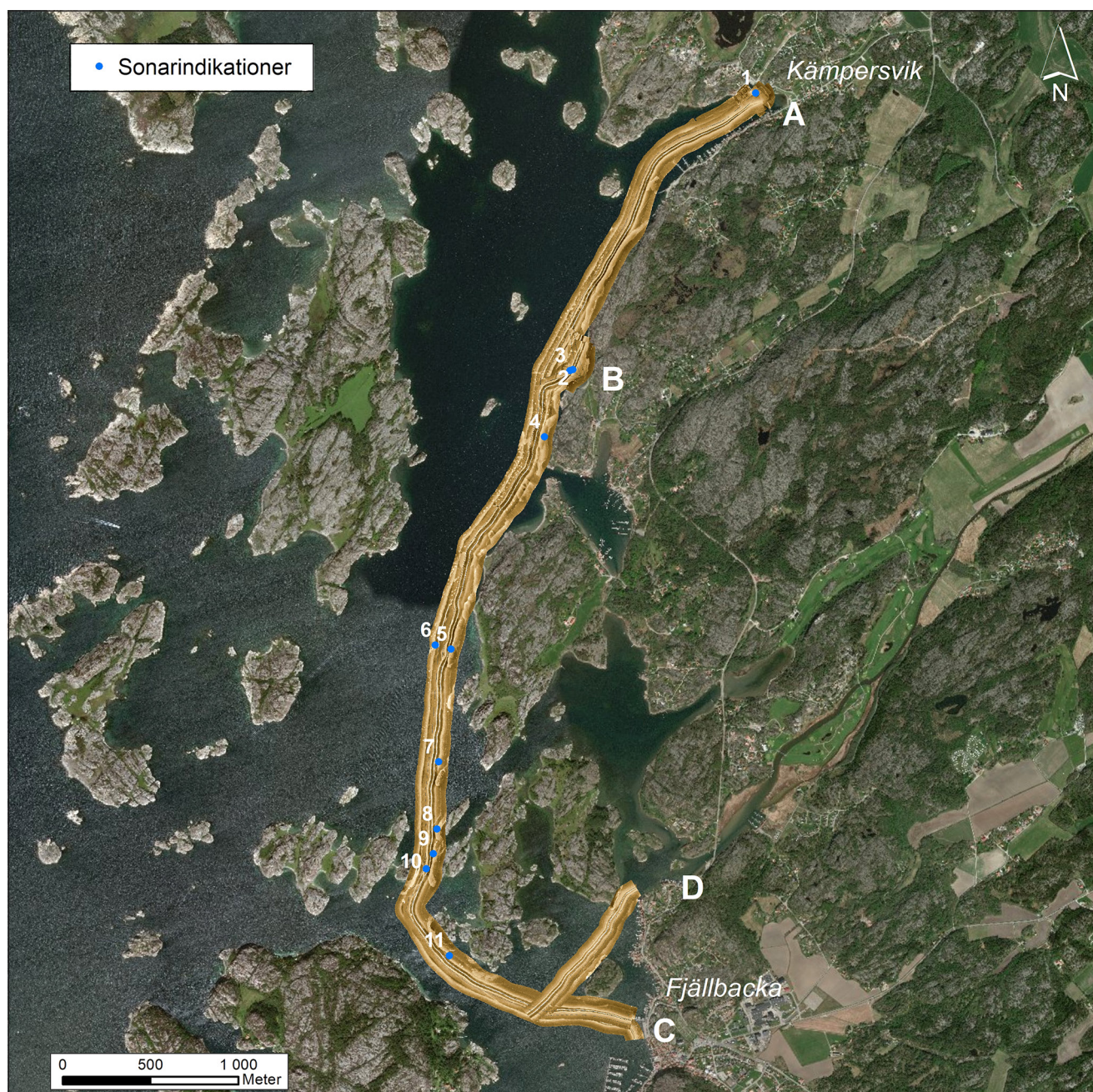
Figur 4. Satellitbild med montage av sonarmosaik som visar det sonarkarterade området mellan Fjällbacka och Kämpersvik samt de elva sonarindikationerna som påträffades vid karteringen. Karta: ESRI, bearbetad av Jens Lindström/NMG.
