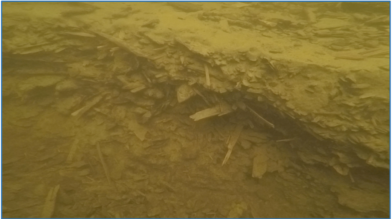
Kuva 7. Sedimentti hyllyn ympäristössä on täynnä puulastuja. Kuvassa pohjaa on kaivettu noin 35 cm syvyyteen saakka.
