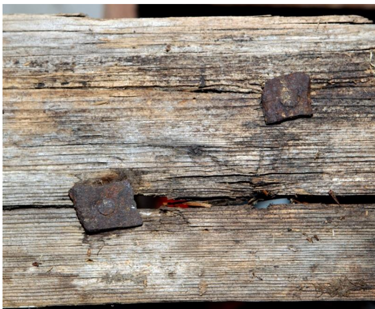
Fig.2. På bilden syns två rombiska nitbrickor som fortfarande sitter fast i bordläggningsplankan. Foto: Nils Olof Engberg
