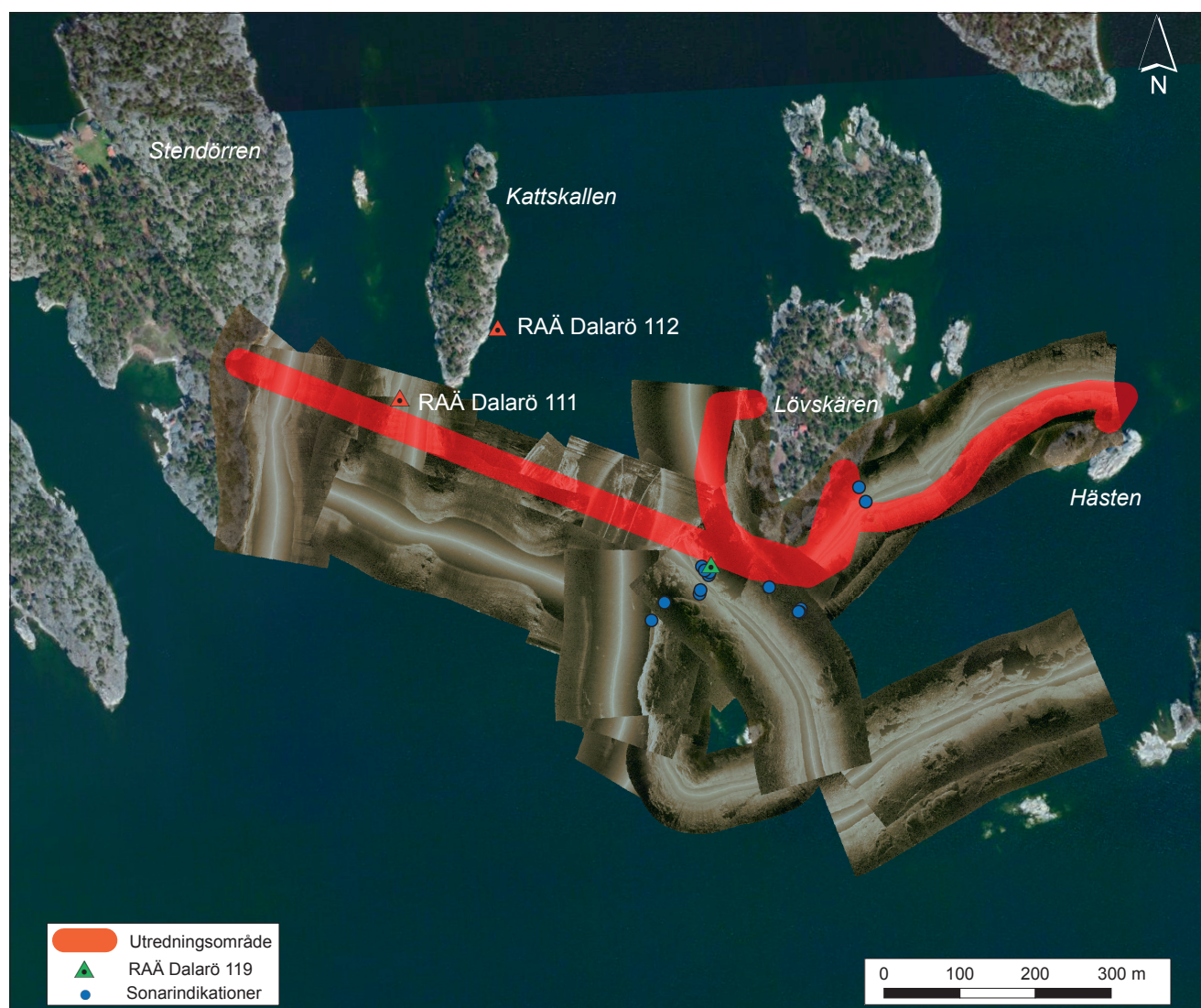
Figur 3. Satellitfoto med montage av sonarmosaik som visar det side scan sonarkarterade området, utredningsområdet, FMIS-objekten som nämns i rapporten samt de side scan sonarindikationer som påträffades och besiktades under utredningen. Karta: ESRI, bearbetad av Jens Lindström/NMG.
