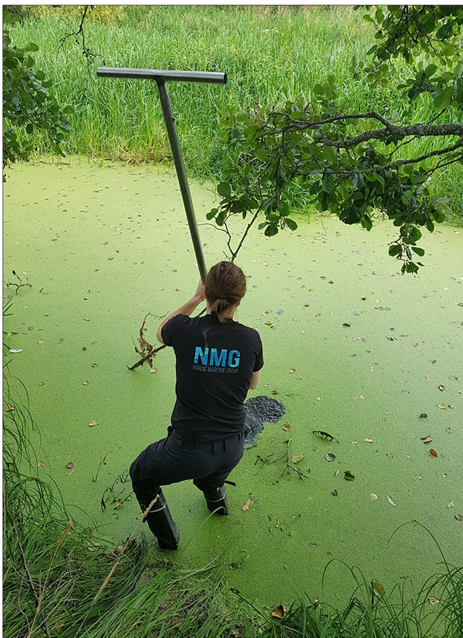
Figur 7. Ryssborren är ett effektivt instrument för att ta upp sedimentprover ur åbotten. Foto: Jens Lindström/NMG.
