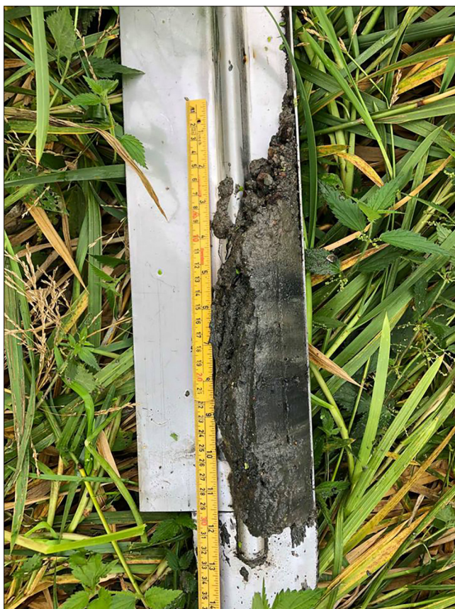
Figur 8. (t.v.) Sedimentprov 1 från den södra delen av utredningsområdet innehåller mestadels varviga gyttjesediment under det översta lagret med sand och grus. Foto: Maija Huttunen/NMG.
