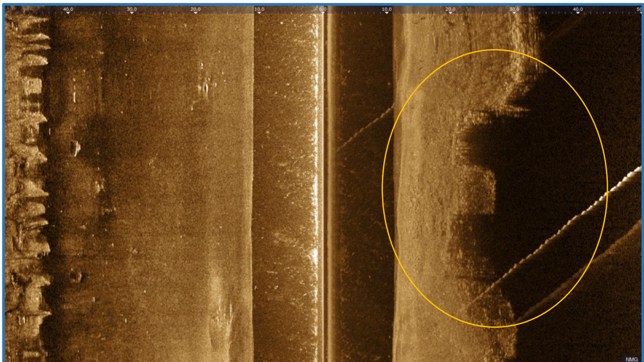
Kuva 7. Sataman laiturirakenteita, puisia paaluja. Vasemmassa reunassa ketjuruoppaajan jälkiä.
