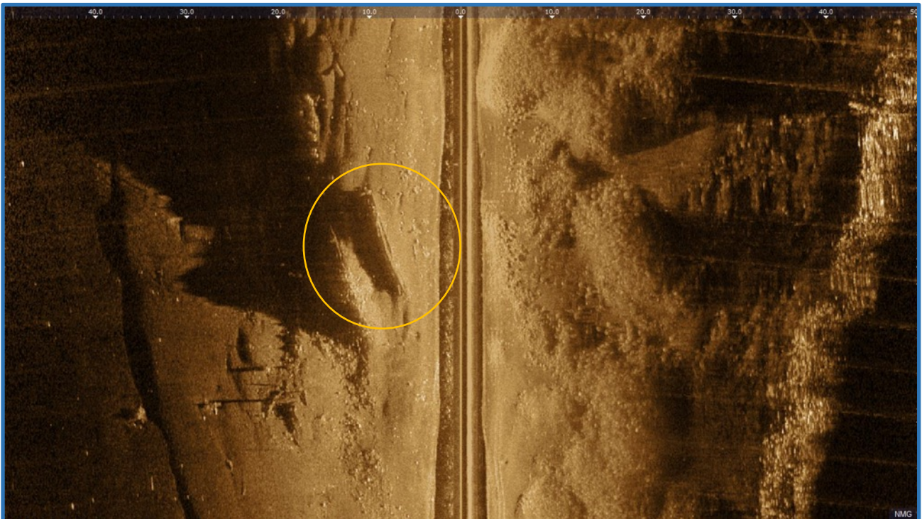
Kuva 3. Erittäin suuri, noin 15 m pitkä rakenneosaa alueella 1. Oikeassa reunassa rantapenger. Sen yli vaakasuoraan kulkevat säännölliset viivat ovat häiriöitä viistokaikumateriaalissa.
