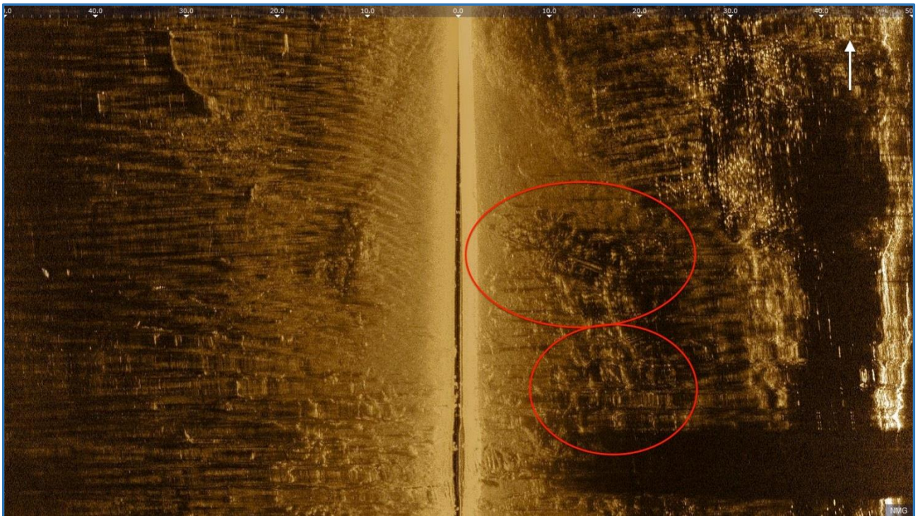
Kuva 11. Viistokaikuluotauskuva kohteesta 1, Länsivallin hylky. Ylempi ympyrä kuvaa varsinaista kohdetta 1, jossa kölilinja on seurattavissa. Alempi ympyrä kuvaa aluetta, jossa on myös hylynosia kerroksittain. Ne voivat liittyä kohteeseen 1 tai 2, mutta vaikuttaa siltä, että kyseessä on vielä useamman hyllyn osia.
